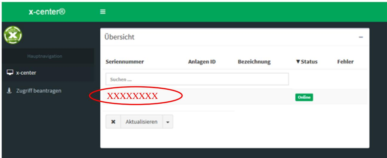
Zur Benutzeroberfläche gelangt man indem zunächst das Gerät ausgewählt und anschließend auf die Schaltfläche „Fernwartung“ geklickt wird.
